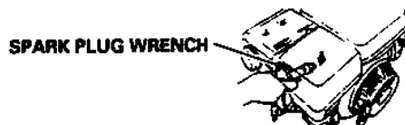
Рис.30: 1 - гаечный ключ для свеч зажигания
