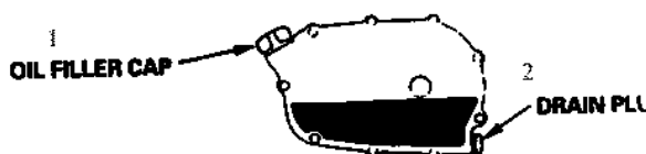
Рис.24: 1 - крышка маслоналивной горловины; 2 - пробка сливного отверстия
